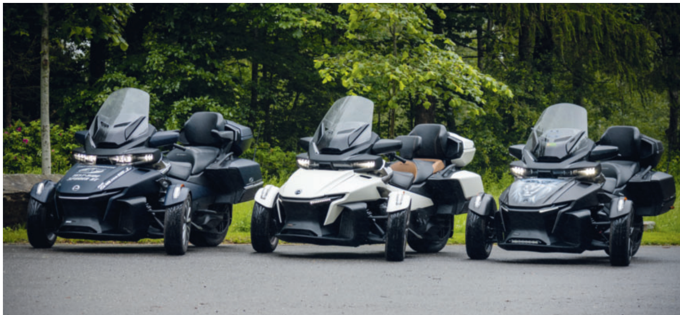
▲ Die Testkandidaten: Links der QRT-Spyder mit Stabilisatoren und progressiven Federn, mittig Original und rechts mit Nachrüst-Federbeinen und Stabilisatoren.
