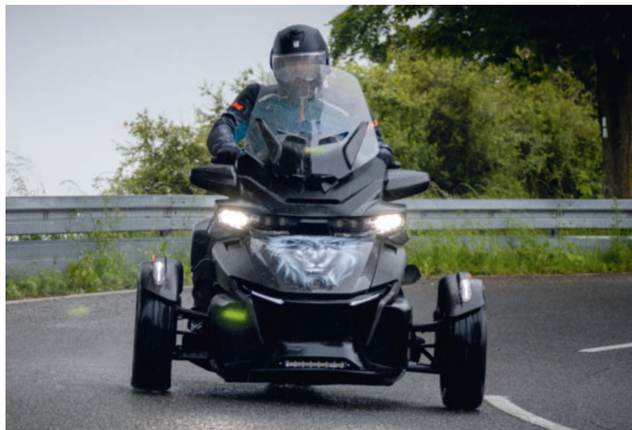
▲ Schon besser: Ralf's Fahrzeug liegt ruhiger und wankt kaum noch. Seine Dämpfung ist weich eingestellt.
