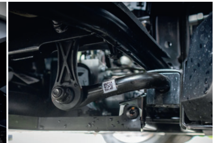
▲ Der macht sich dünn: Die originalen Stabilisatoren messen nur 14 Millimeter im Durchmesser.
