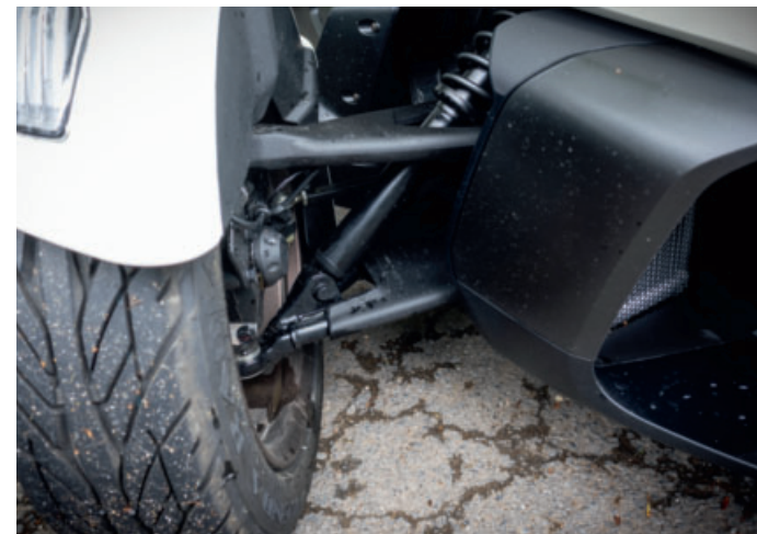
▲ Softie: Die Einstellung der Seriedämpfer ist sehr weich und auf absoluten Komfort ausgelegt.
