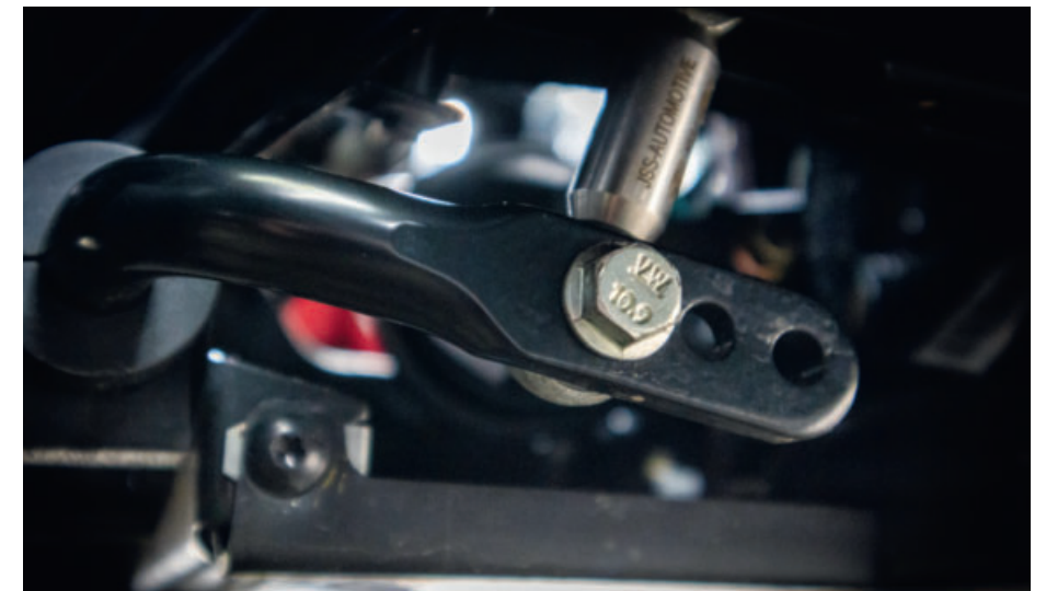
▲ Ein dicker Hund: Einstellbare Stabilisatoren mit 18 Millimeter Durchmesser.
